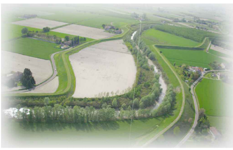
B.1.9 - Intervento di ripristino spondale in corrispondenza dello stante sx 240 e sx 241
